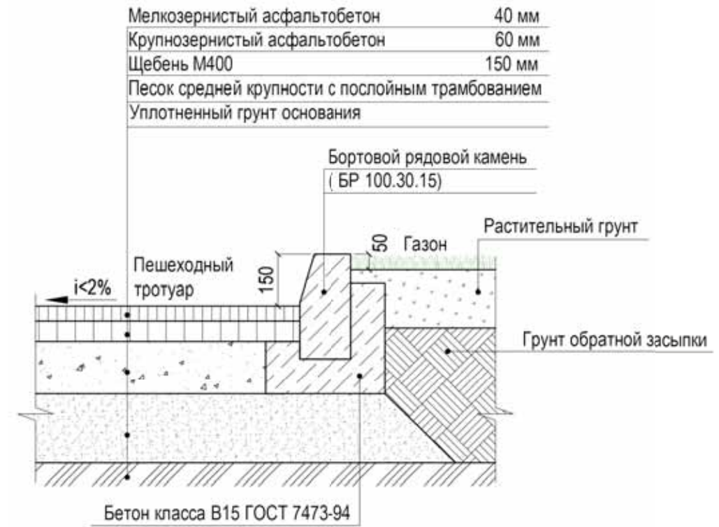
3.13.1 Схема устройства сопряжения асфальтобетонного покрытия и газона
