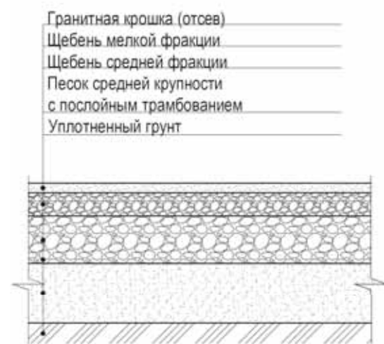
3.6 схема устройства основания под набивное покрытие
