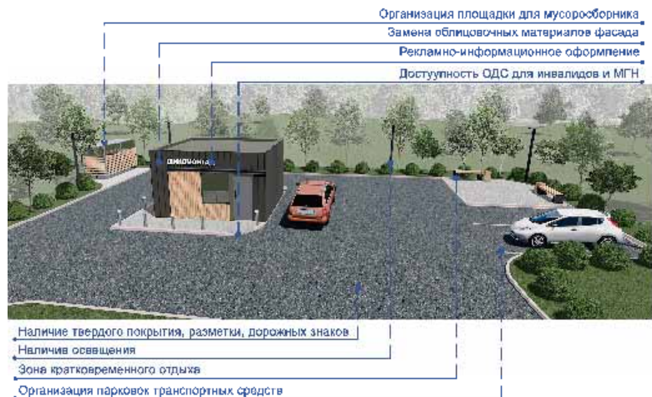
Вариант 1 Пример приведения шиномонтажной мастерской к требованиям Стандарта с минимальным перечнем работ
