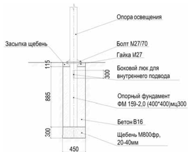
3.16 Схема монтажа опоры освещения
